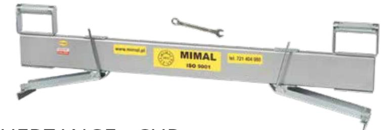
Sie dient zum Transportieren und Versetzen von Bordsteinen und anderen Betonelementen. Eine Zange wird von zwei Personen bedient, die den Bordstein quer halten, also umgekehrt als im Falle einer Längzange. Die Schneiden sind mit Gummielementen ausgestattet, die einen wirksamen Griff für bewegliche Teile bieten. Die Querzange wurde mit abnehmbaren Griffen ausgestattet, für einen leichten Transport und bequeme Aufbewahrung.
