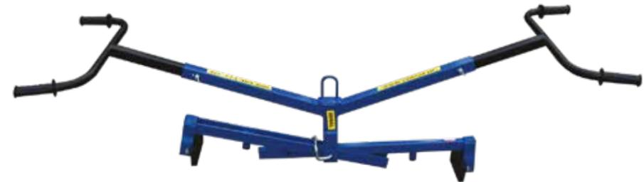
Sie wird zum Tragen und Versetzen von Platten PIASTRA (1200x900x100 [mm]) verwendet. Eine zusätzliche Öse in der Mitte der Zange ermöglicht das Aufhängen der Maschine unter dem Bagger oder einer ähnlichen Maschine mit dieser Funktion. Das Gerät ist mit speziellen Abstandshaltern aus Kunststoff ausgestattet, um die Oberschicht der Platte vor Beschädigungen zu schützen. Um ihren Transport und Aufbewahrung zu erleichtern, wurde die Zange mit abnehmbaren Griffen ausgerüstet.
