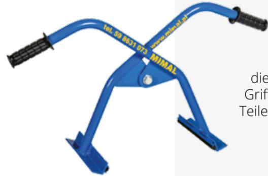
Sie dient zum Bewegen und Versetzen von Bordsteinen und anderen Betonelementen. Eine Zange wird von einer Person bedient, die den Bordstein quer hält, also umgekehrt als im Falle einer Längzange. Die Schneiden sind mit Gummielementen ausgestattet, die einen wirksamen Griff für bewegliche Teile bieten.
