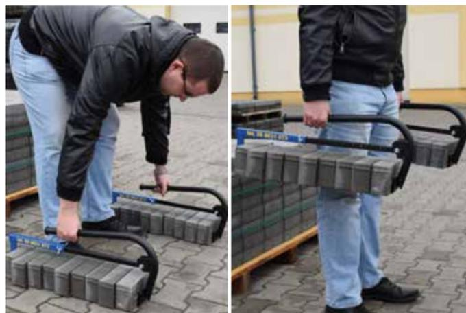
Zangen werden zum schnellen und sicheren Ergreifen von Ziegeln, Klinker oder Pflastersteinen eingesetzt. Das Ergreifen von Ziegeln oder Pflastersteinen erfolgt auf Selbstklemmbasis, d. h. sehr schnell. Für den Transport der Elemente werden zwei Werkzeuge verwendet (beide Hände werden gleichmäßig belastet), was die Produktivität deutlich erhöht und die Ergonomie verbessert.
