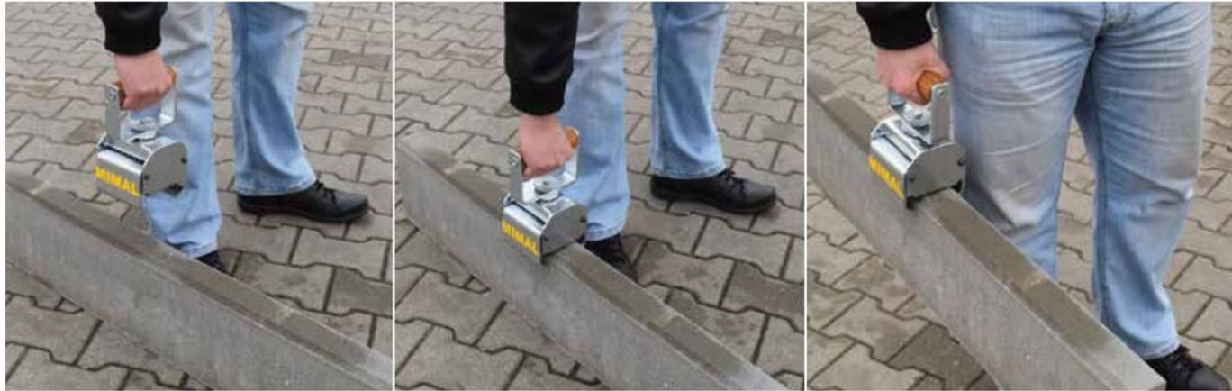
Die Koffer-Handzange wird zum Transport und Versetzen von Bordsteinkanten eingesetzt. Die Zange verfügt über einen Mechanismus zur stufenlosen Einstellung der Breite.
