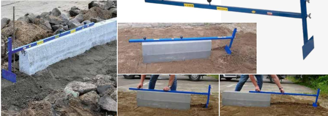
Es wird verwendet, um die Oberfläche zu nivellieren, an Stellen, wo später Bordsteine gesetzt werden. Das einfache Gerät erhöht die Leistungsfähigkeit. Die Schiene verfügt über einen Mechanismus zur Einstellung der Höhe.
