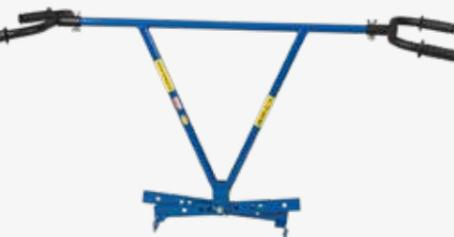
Sie wird zum Transport und Versetzen von Abwasserrinnen mit einem Gewicht bis 120 kg verwendet. Sie wird von zwei Personen bedient. Um ihren Transport und Aufbewahrung zu erleichtern, wurde die Zange mit abnehmbaren Griffen ausgerüstet.
