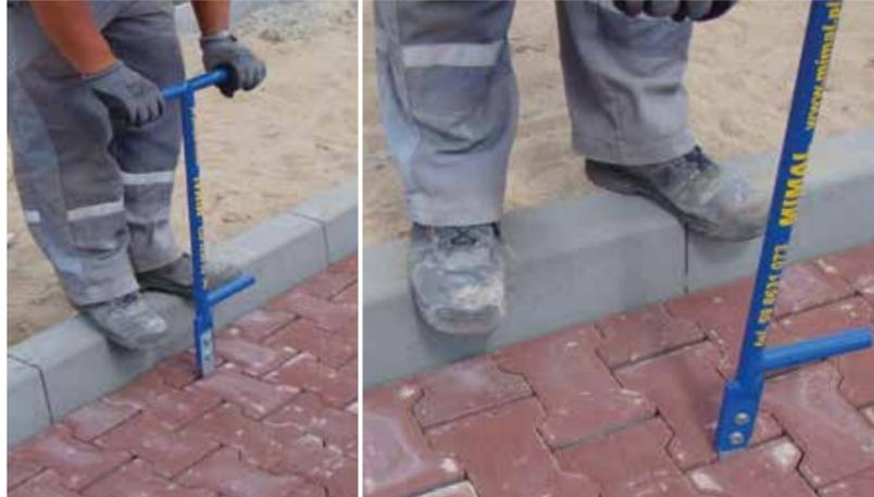
Es dient zum Planieren und Transportieren von Pflastersteinen und Straßenplatten. Das Brecheisen ist mit austauschbaren, gehärteten Endstücken versehen, die als Ersatzteile erhältlich sind.
