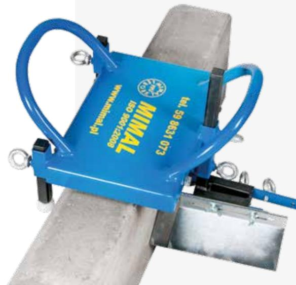
Sie werden zum Tragen und Versetzen von Ajourplatten und Betongittern unter dem Rasen eingesetzt. Die Zangen passen perfekt zu den Steinen mit Öffnungen von etwa 100 x 100 mm. Die einstellbare Länge der Griffe ermöglicht es Ihnen, das Werkzeug an die Größe jedes Arbeiters anzupassen.
