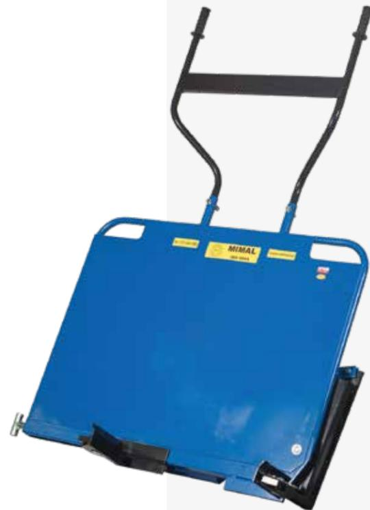
Der Pflastersteinhalter wird verwendet, um den Pflasterstein während des Schneidens auf die gewünschte Länge oder Breite zu befestigen, ohne eine Verletzung des Fußes zu riskieren. Der Griff hat eine stufenlose Einstellung der Breite und eine allmählichen Höheneinstellung, die es erlaubt, die Pflastersteine entlang und quer zu schneiden. Der Griff am Gehäuse erleichtert den Transport auf der Baustelle.
