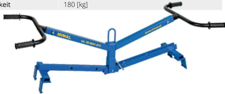
Sie wird zum Tragen und Versetzen von Jumbo-Platten verwendet. Diese Zange kann als handbetätigtes Werkzeug verwendet werden, das von zwei oder vier Personen oder als mechanische Vorrichtung betrieben wird, die an einem Bagger oder einer ähnlichen Maschine hängt. Je nach Bedarf können Jumbo-Platten von außen oder von innen (in Löchern) erfasst werden. Die Griffe werden demontiert, um den Transport und die Lagerung zu erleichtern. Das Gerät ist mit austauschbaren Stiften ausgestattet.
