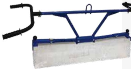
Sie wird verwendet, um Bordsteine manuell und mechanisch zu transportieren und den Bordstein von der Stirn zu ergreifen. Um ihren Transport und ihre Aufbewahrung zu erleichtern, wurde die Zange mit abnehmbaren Griffen ausgerüstet. Eine zusätzliche Öse in der Mitte der Zange ermöglicht das Aufhängen der Maschine unter dem Bagger oder einer ähnlichen Maschine.
