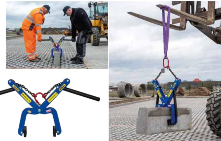
Sie wird zum Tragen und Versetzen von Keramikplatten mit Abmessungen von 60-150 cm verwendet. Das Ergreifen der Platten erfolgt auf Selbstklemmbasis. Die Griffendstücke wurden mit Kunststoff für einen festeren Griff abgedeckt. Spezielle Griffe gewährleisten eine hohe Effizienz und erleichtern den Materialtransport. Das Aluminiumprofil sorgt für die Leichtigkeit und Ästhetik des Geräts.
